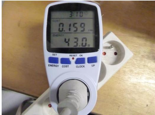
**Mesurer une puissance :** Choisir l'unité W dans la partie inférieure avec le bouton ENERGY. Sur l'exemple, la puissance est de 43 W. Il est aussi possible de connaître la puissance maximale et minimale depuis le début du branchement en cherchant l'unité W MIN ou W MAX en haut de la case.
